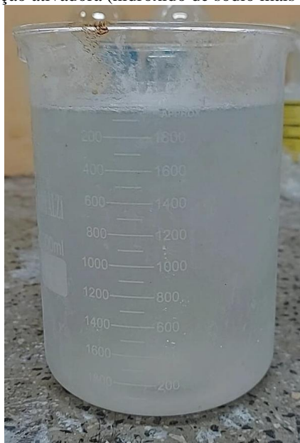
Figura 50 – Solução ativadora (hidróxido de sódio mais silicato de sódio).
