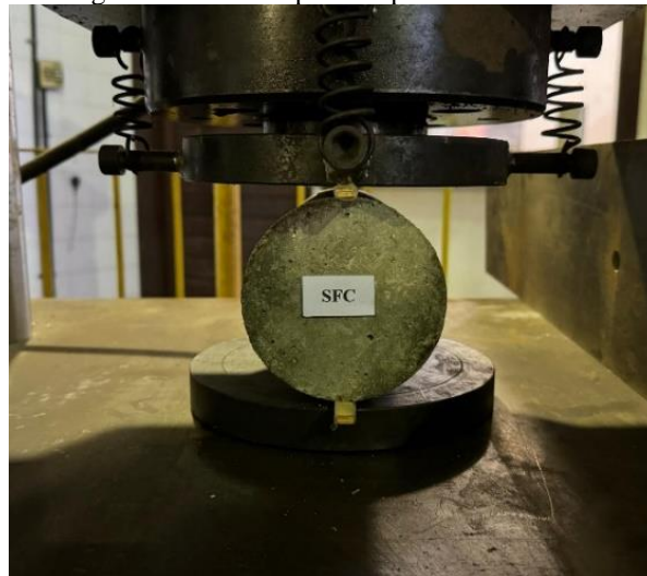
Figura 57 – Ensaio por compressão diametral.
