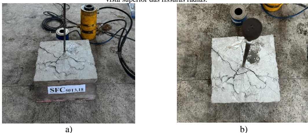
Figura 63 – Modo de ruptura do bloco SFC50T3,18: (a) formação do cone de concreto e das fissuras radiais; (b) vista superior das fissuras radiais.
