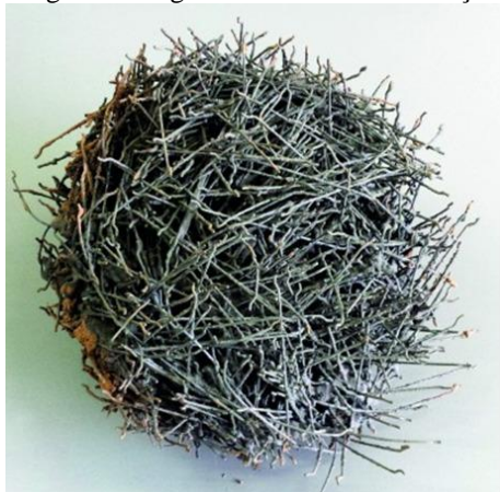
Figura 6 – Aglomerados de fibra de aço.
