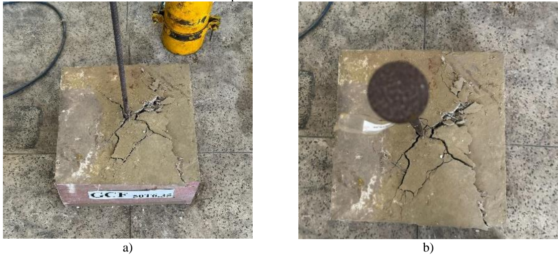
Figura 73 – Modo de ruptura do bloco GCF50T6,35: (a) formação do cone de concreto e das fissuras radiais; (b) vista superior das fissuras radiais.
