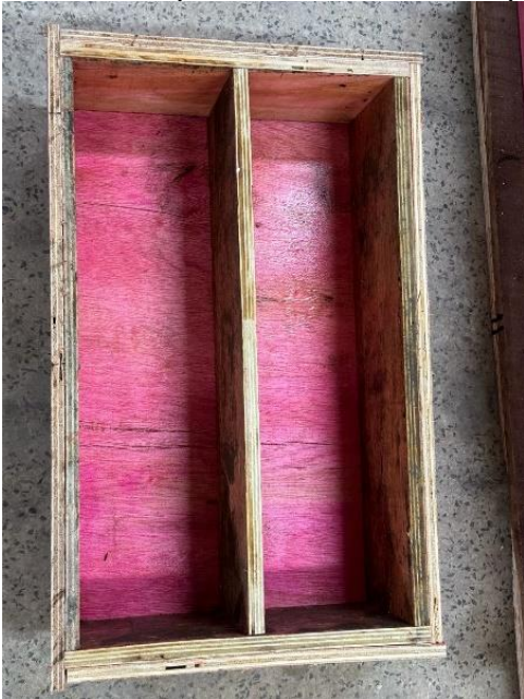
Figura 47 – Prismas para ensaio a flexão em três pontos.
