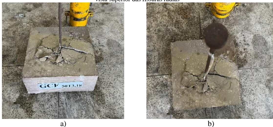
Figura 72 – Modo de ruptura do bloco GCF50T3,18: (a) formação do cone de concreto e das fissuras radiais; (b) vista superior das fissuras radiais
