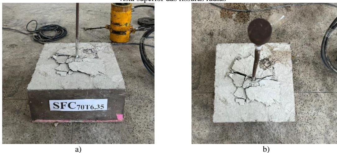
Figura 66 – Modo de ruptura do bloco SFC 70T6,35: (a) formação do cone de concreto e das fissuras radiais; (b) vista superior das fissuras radiais
