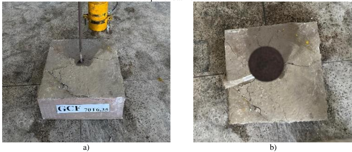
Figura 74 – Modo de ruptura do bloco GCF70T6,35: (a) formação do cone de concreto e das fissuras radiais; (b) vista superior das fissuras radiais.
