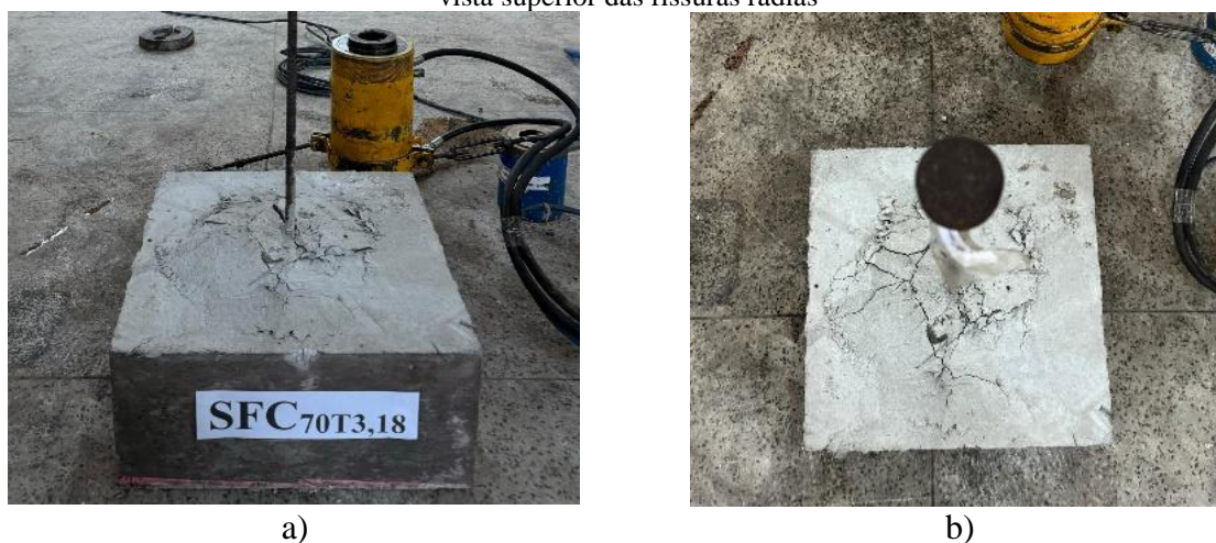
Figura 65 – Modo de ruptura do bloco SFC 70T3,18: (a) formação do cone de concreto e das fissuras radiais; (b) vista superior das fissuras radiais
