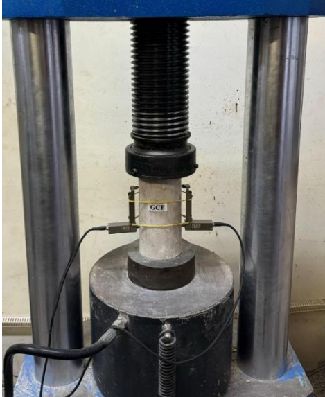
Figura 56 – Ensaio de módulo de elasticidade.
