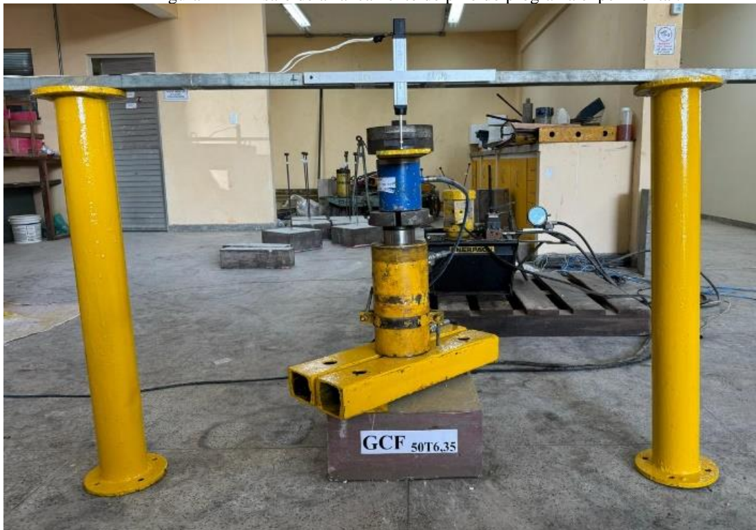
Figura 41 – Ensaio de arrancamento de pino do programa experimental.
