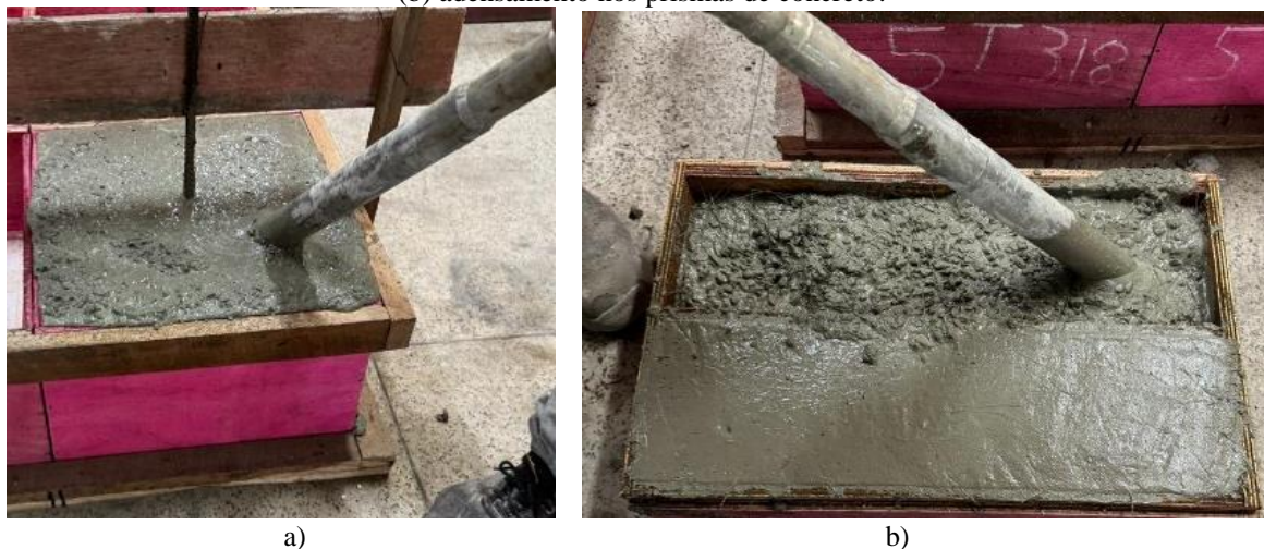
Figura 48 – Adensamento com auxílio do vibrador de imersão: (a) adensamento no bloco de concreto; (b) adensamento nos prismas de concreto.
