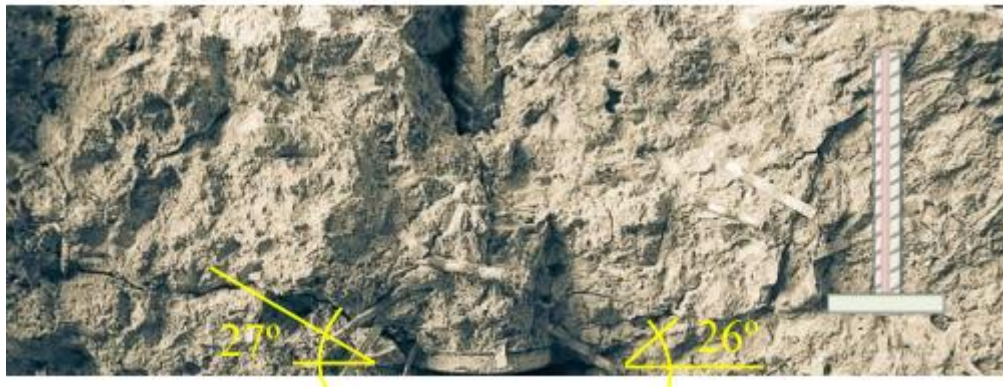
Figura 5 – Efeito “costura” proporcionado pelas fibras.
